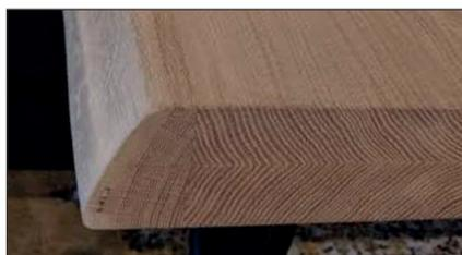
mit der selben Lamelle aufgedoppelt
