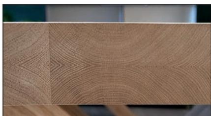
mit der selben Lamelle umgeklappt
