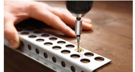
Bei stark ausgetretenen Stufen wird ein Stabilisierungsprofil an der Treppenkante angebracht.
